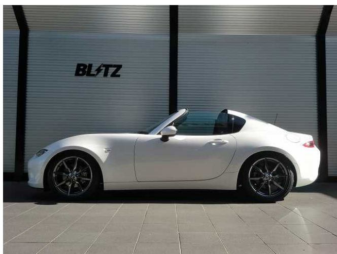
フロント:-46mm ダウン / リア:-49 mmダウン
