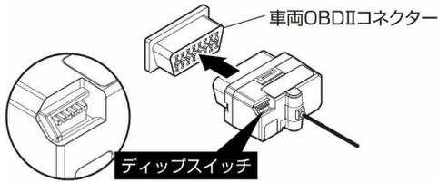
OBDIIアダプター適合表の「SW設定」の番号を参照し、ディップスイッチを設定します。
