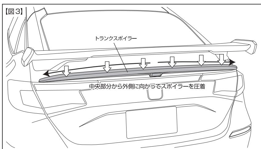
⑤T/S 取付部周辺をしっかりと脱脂し、②にて合わせたマークリング位置に T/S をしっかりと合わせます。
