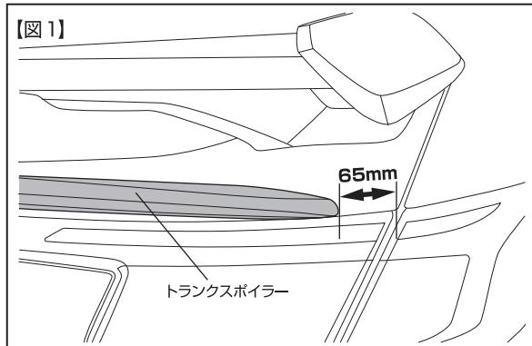
①作業前に本書を良く読み、付属品が揃っているか確認し、各指示や注意事項に必ず従って作業して下さい。次にボディー保護の為、トランクspoiler（以下T/S）取付部分周辺をマスキングテープ等で保護します。
