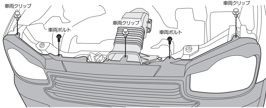
⑦F/B を車両に被せ、取外したカブラーを接続し、以下のボルト・クリップを仮止めした後、各灯火類やセンサー類の作動確認を行います。
