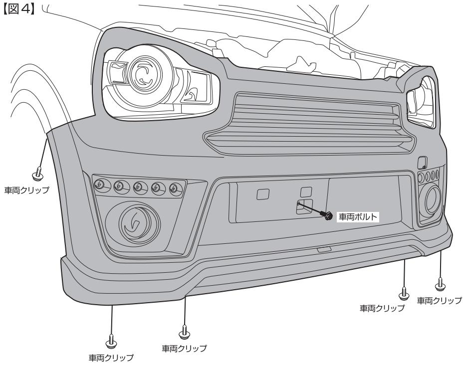
⑧純正牽引カバー及びライセンスプレートを移設します。最後に各部のボルト・スクリュー類がしっかりとしまっている事を確認して、付属のカーボンエンブレムをF/B 中央部分に貼り付け、全体のガタツキ等がないか確認したら作業終了です。
