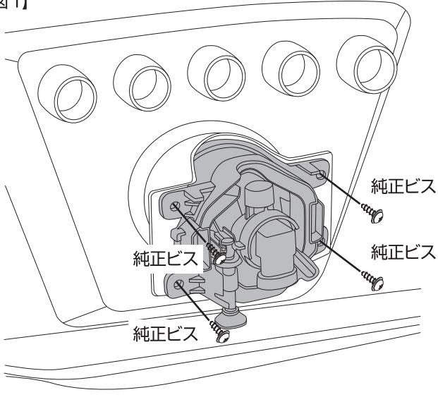
⑤フォフランプをF/Bに取付けます。取付けは、純正フォグランプのビスを使用にて、片側4箇所づつ取付けます。（図1参照）
