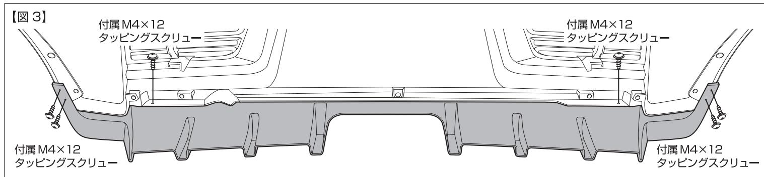
④一度R/DFをマスキングテープ等を使用して付位置にしっかりと固定した後、R/DFに開いている取付穴を利用して純正バンパーに穴位置をケガキ針やガビュウでガイド穴を開け、付属のM4×12タッピングスクリューにて締込みながら取付けます（片側3箇所づつ）。（図3参照）
