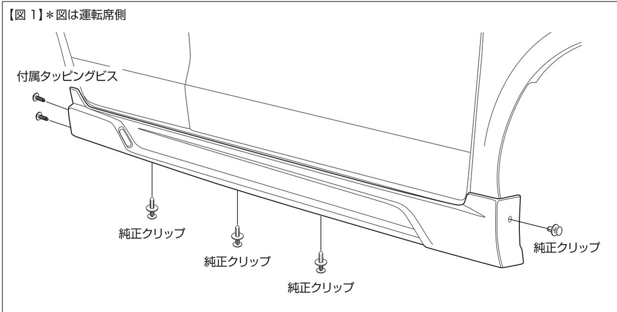
③取付けは、フロントタイヤハウス内は①にて取外した純正クリップにて1箇所・S/S 下部は①にて取外した純正クリップにて3箇所取付けます。又リヤタイヤハウス内は、取付穴をボディにマーキングし、ドリル等で3.6mmの穴あけを行い、付属のM4×15 タッピングスクリューにて締込みながら上下2箇所取付けます。(図1参照・左右)
