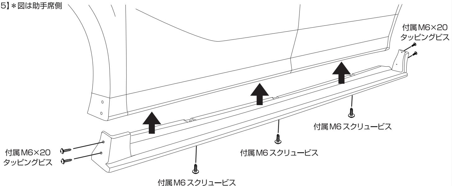
⑦フロント及びリヤタイヤハウス内は付属のM6×20タッピングビスを利用して2箇所づつ取付け、S/S底面は③にて取付けたグローメットを利用して、付属のM6スクリューにて3箇所取付けます。(図5参照)
