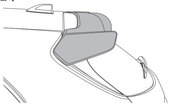
①作業前に本書を良く読み、付属品が揃っているか確認し、各指示や注意事項に必ず従って作業して下さい。次にボディー保護の為、リアス poiler (以下R/S) 取付部分周辺をマスキングテープ等で保護します。
