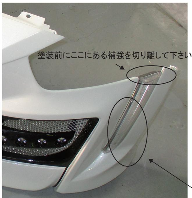
付属の M5 ボルトで固定して下さい（左右各 2 箇所）
