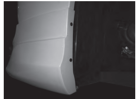
図3 左右2か所ずつタッピングビスを使用して確実に固定してください。
