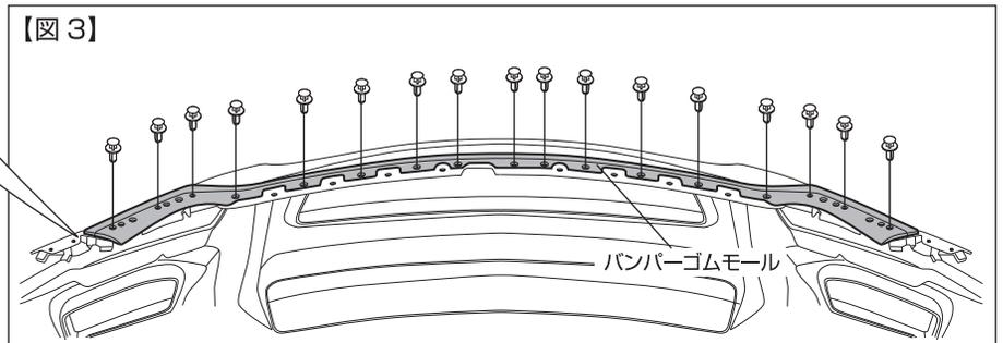
⑥純正バンパーからバンパーリテナー及びバンパーゴムモールを取外し、F/Bに移し替えます。純正同様に、バンパーリテナーは車両ボルトにて2箇所（左右）取付け、バンパーゴムモールは車両クリップにて17箇所取付けます。（図2/図3参照）
