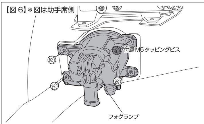
⑨純正バンパーからフォグランプを取外し、F/Bに移し替えます。車両タッピングビスと付属のM5 タッピングビスにて4箇所固定して下さい。(図6参照・左右)
