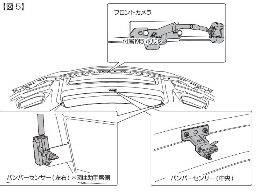
⑧純正バンパーからフロントカメラ及びバンパーセンサー(中央・左右)を取外し、F/Bに移し替えます。フロントカメラは付属のM5 ボルト/ナットにて固定し、バンパーセンサーは純正同様に車両ボルト/ナットにて固定して下さい。(図5参照)
