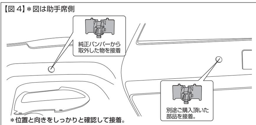
⑦純正バンパーからディスタンスセンサー ブラケット左右を取外し、別途ご用意して頂きましたエポキシ樹脂系接着剤にて、F/B裏側のバンパーセンサー穴位置に接着して下さい。また、フロントグリル部分のディスタンスセンサーはバンパーに移動させますので、別途お買い求め頂いたディスタンスセンサー ブラケットを接着して下さい。さらに、ディスタンスセンサー ブラケットの取付位置及び向きは純正を参照して間違えないようにご注意ください。（図4参照）
