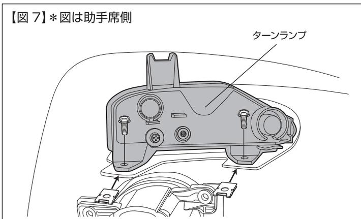
⑩純正バンパーからターンランプを取外し、F/Bに移し替えます。純正バンパーからスピードナットをF/Bに移し替え、車両ボルトにて2箇所取付けます。(図7参照・左右)
