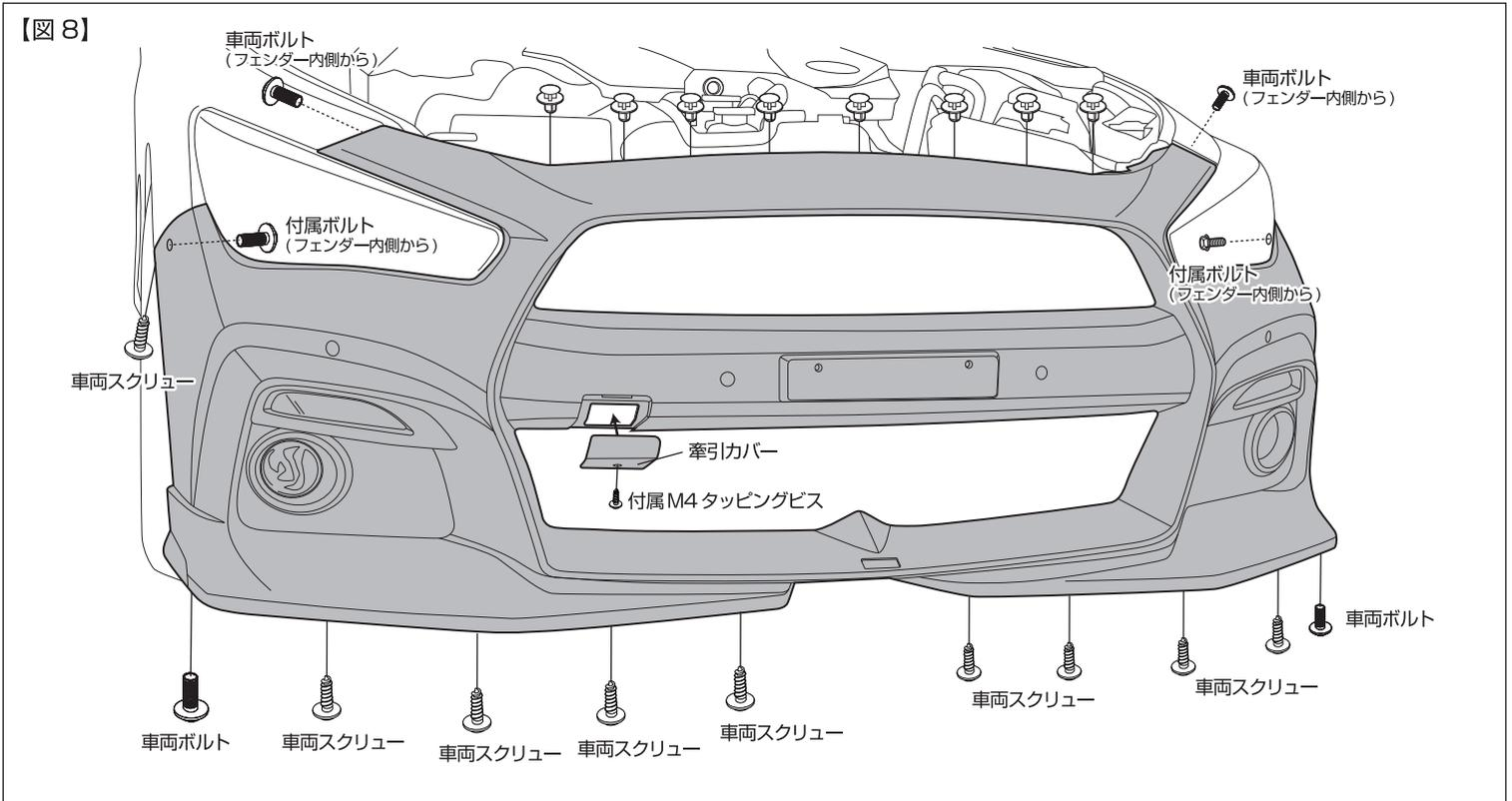
⑫純正バンパーからバンパー下面のスピードナット8箇所を取外し、F/Bに移し替えます。
