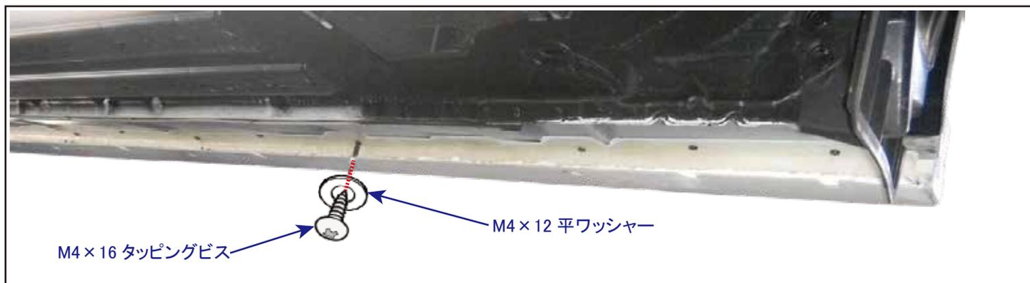
⑥付属のステーとボルトを製品側に組み付けます。
