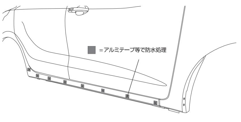
⑥図を参照に、取外した純正サイドスカートの取付穴8箇所は使用致しませんので、アルミテープ等で防水処理し、S/S取付部周辺をしっかりと脱脂します。【図3参照・左右】
