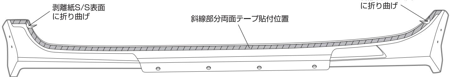
⑤付属の両面テープを本製品裏側に貼り付けます。【図2参照・左右】
