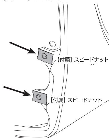
④付属のスピードナットを、純正サイドスカート タイヤハウス内の取付位置（ボディー穴部分）に取付けます。フロント側はインナーカバーのクリップを一度外して、インナーカバーをめくって取付けて下さい。【図1参照・左右】
