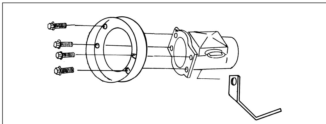
②①で組み立てたエアフローメーターを純正のサクションチューブに取り付けて下さい。
