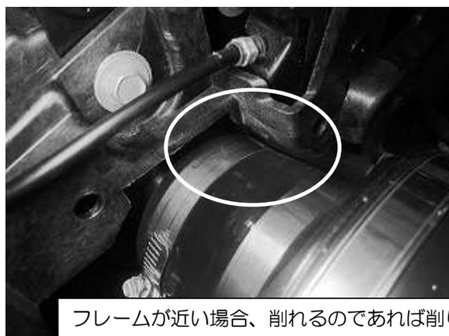
フレームが近い場合、削れるのであれば削り、削れなければ緩衝材を貼り付けて下さい
