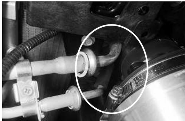
エアコンパイプが近い場合は曲げて下さい。曲げられない場合は干渉材を巻いて直接の干渉を防いで下さい
