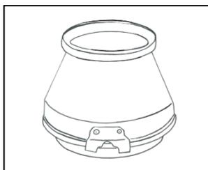
ロックプレートを、M4 六角頭ビスを使用して組み付けます。
