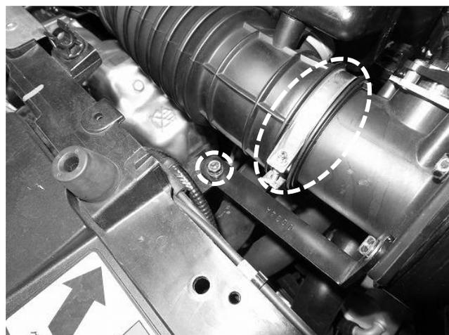
7. エアフロセンサーカプラーを取付けます。
