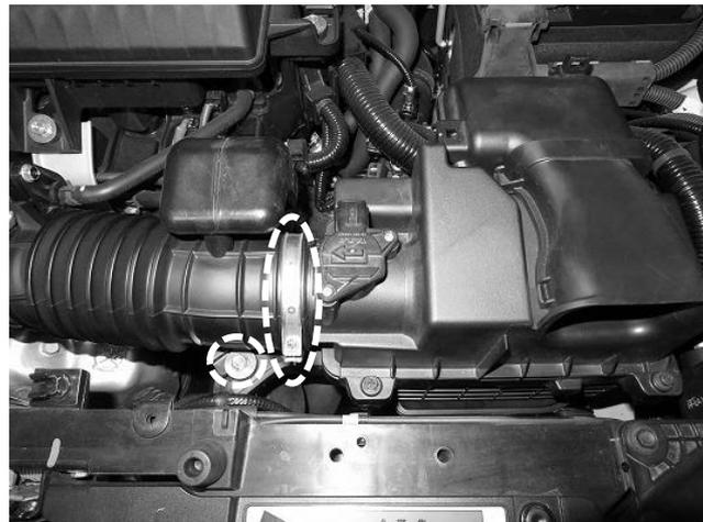
3. クリーナーBOX 固定ボルトを1個所取外します。
