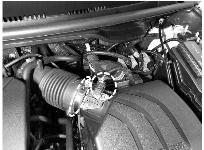
3. 可変バルブアクチュエーターのコネクタを取り外し、クリーナーボックス下部から取外します。
