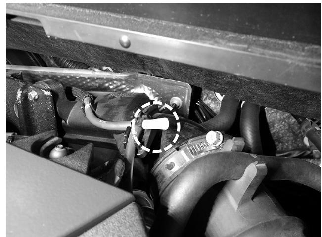
6. 可変バルブアクチュエーターを元のコネクタに接続し、他のハーネス類にタイラップで固定します。
