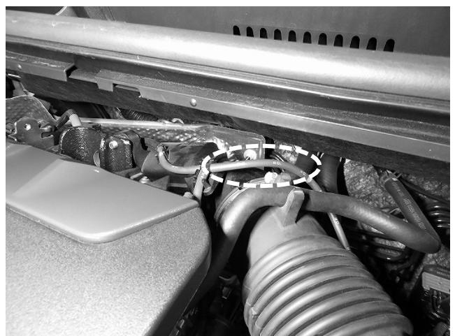
5. クリーナーボックス下部を取り外し、ボックス固定用ゴムブッシュ 2 個を取り外します。
