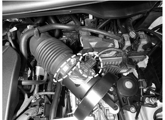
12. 純正導入ダクトをヒートシールドに差し込み、純正クリップで固定します。
