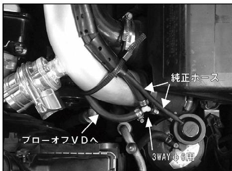
※写真はブローオフバルブDDの取り付け例ですが、ブローオフバルブBRにおいても同様に取り付けてください。
