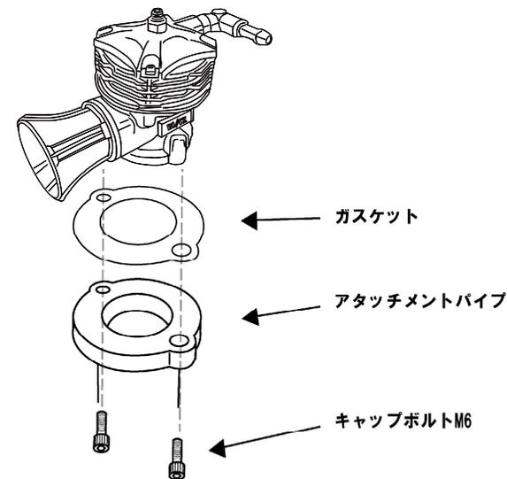
(2) ブローオフBR本体を組み付けたアタッチメントパイプを図のように車両へ取り付けてください。(取り付けは純正のクランプを使用してください)
