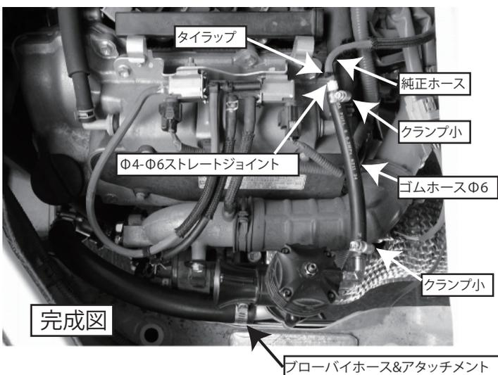
(6) 図を参考にゴムホースΦ6をΦ4-Φ6ストレートジョイント、クランプ小を使用し純正ホースに接続します。ゴムホースΦ6が長い場合は適当な長さにカットしてご使用ください。
