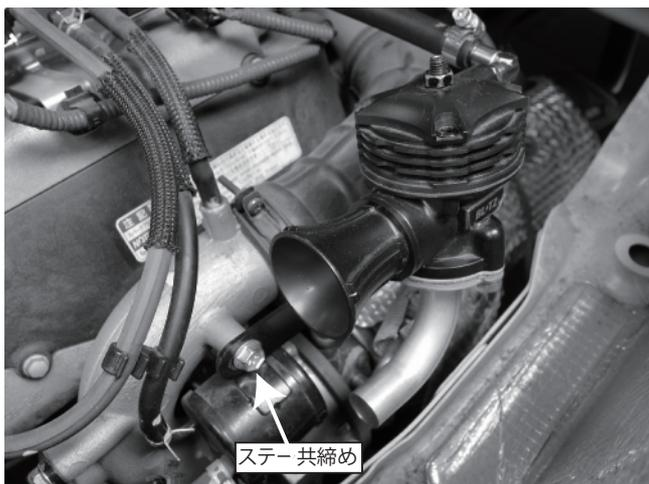
(4) 前の手順で組み立てた本体キットを図を参考に純正のボルトを使用してステアと共締めします。
