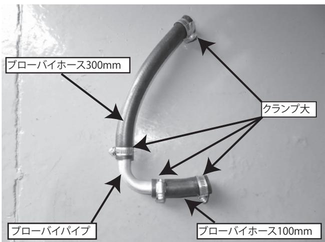
(5) ブローバイホースとブローバイパイプを図を参考にクランプ大を使用して組み立てます。
