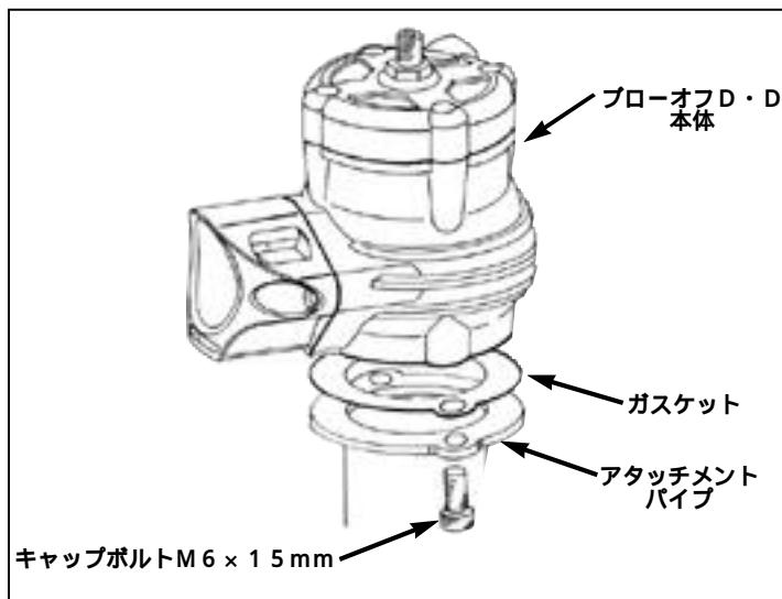
(1) 取り外した純正のエアチューブの代わりに付属のクランプ 55用2ヶ、ゴムホース(55)2ヶを使用しアタッチメントパイプを取り付けて下さい。
