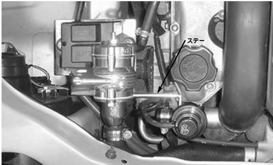
**お願い** 取り付けたブローオフDDと、周囲の純正品とのクリアランスを十分に確保してクランプを固定して下さい。
