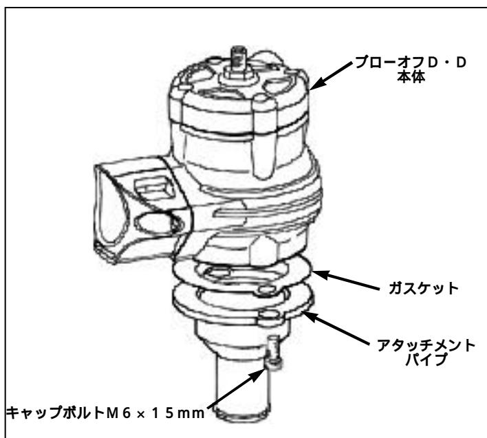
(3)(1)で組み付けたブローオフDD本体とアタッチメントを図のよう取り付けて下さい。
