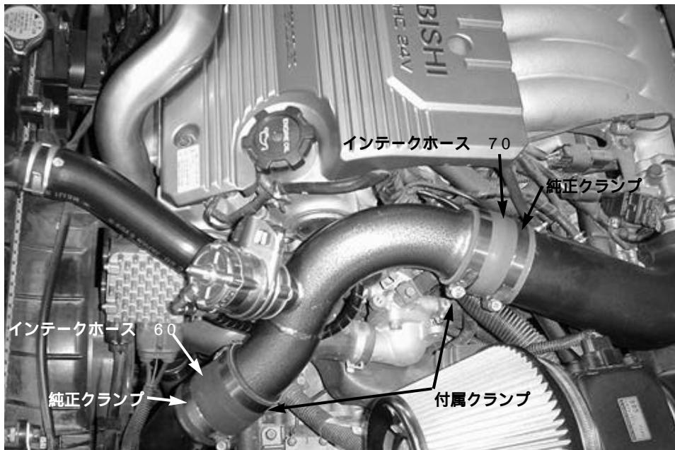
(4)図の矢印部からバキュームホース抜き、ブローオフDDのバキュームニップルに配管して下さい。(純正のクランプを再使用して下さい。)
