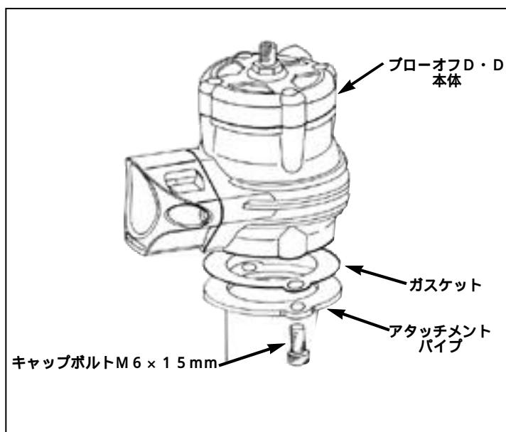
(3)(2)で組み立てたブローオフDDを、図のように配管して下さい。
