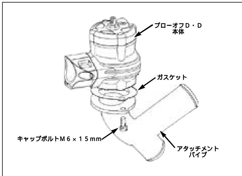
(2)(1)で組み立てたプローオフDDを、図のように配管して下さい。
