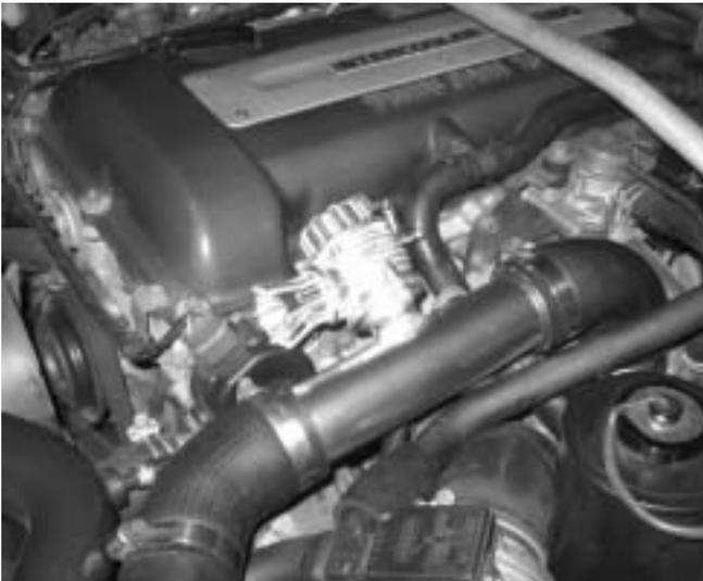
クランク角センサー及び、ボンネットとのクリアランスを確保してクランプを固定してください。
