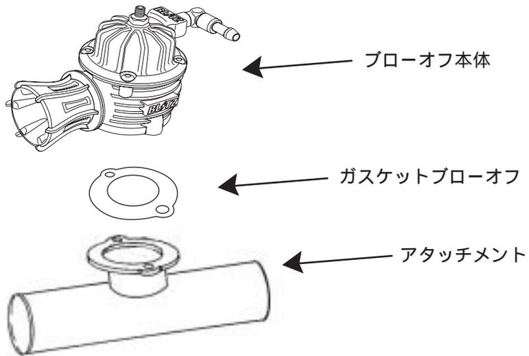
(1) インレットチューブを外した位置にキット付属のアタッチメントを取り付けてください。
