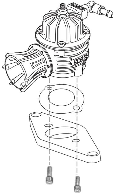
(2) (1) で組み付けたブローオフバルブ本体を、下図を参考に純正ボルトを使用して固定してください。(純正ガスケット再使用)
