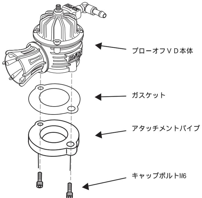
(2) ブローオフVD本体を組み付けたアタッチメントパイプを図のように車両へ取り付けてください。(取り付けは純正のクランプを使用してください)
