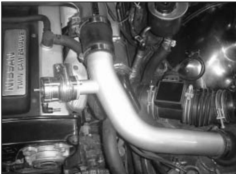
(3) キャニスターへ入っているバキュームホースを付属の3WAY 6用で分岐させてブローオフVD本体のバキュームニップルへ配管してください。
