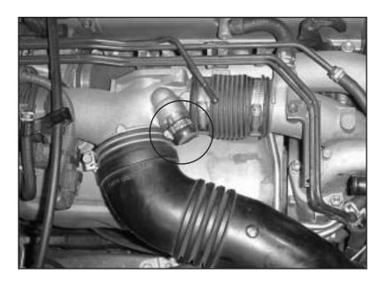
(3) ブローオフ本体を組み付けたアタッチメントを下図のように車両へ取り付けてください。
