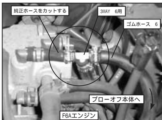
図中 部のゴムキャップを取り外し、ブローオフVDへ配管してください。
