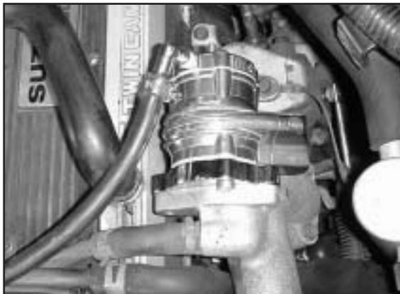
写真はブローオフバルブDDの取付例ですが、ブローオフバルブVDも取付方法は同様です。
