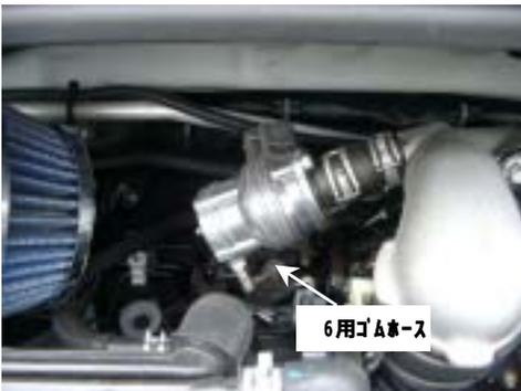
(7) 2-(5) で取付けたゴムホース 6 を図のようにブローオフ本体のニップルに配管する。クランプ 6 用を使用してください。
