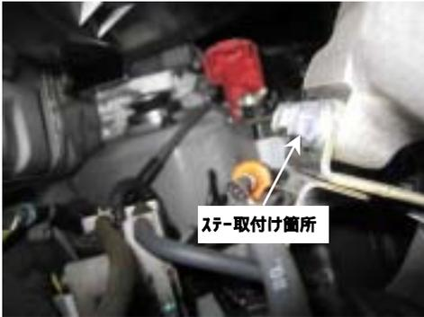
(6) 組み立てたブローオフ ASSY を 1-(1) で外したエアバイパスホース と付属の 22 用クランプを使用してエンジンに取り付ける。
