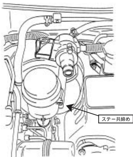
ブローオフバルブ本体が他の部品と干渉しないよう本体の向きを調整して固定してください。
