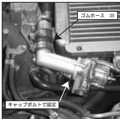
図中の写真はブローオフバルブD D取付例ですが、ブローオフバルブV Dにおいても取付方法は同様です。
