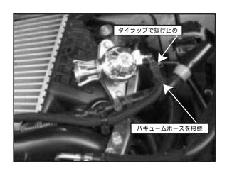
(4) エンジンカバーを取り付ける場合は、ブローオフ本体に干渉する部分をカットしてください。
