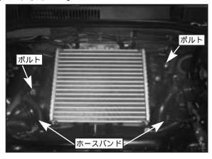
(3)ボルト、クランプを取り外し、エアバイパスパイプを取り外してください。 また、取り外したサクション部へ付属のゴムキャップ 28用を取り付けてく ださい。(取付は、付属のクランプ 28用を使用してください。)
