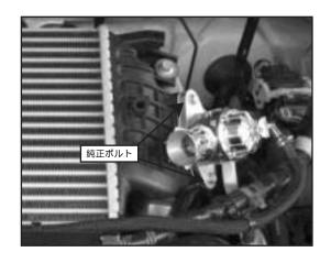
(3) インタークーラーを取り外しと逆の手順で取り付けてください。 エアバイパスバルブに配管されていたバキュームホースをブローオフ本体の バキュームニップルへ接続してください。 (バキュームホースは付属のタイラップで抜け止めをしてください。)
