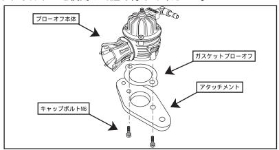
(2)組み付けたブローオフASSYをインタークーラーに純正ボルト使用して組み付けてください。(付属のガスケットフランジを挟んで取り付けてください。)
