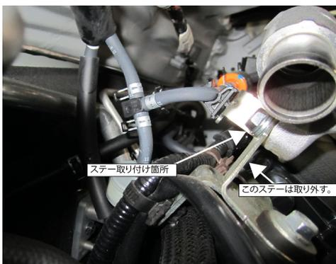
(6) 組み立てたブローオフ ASSY を1-(1)で外したエアバイパスホース①と付属のΦ22用クランプを使用してエンジンに取り付ける。純正のステーは取り外します。
