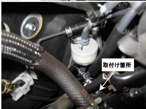
(4) 1-(1)でバキュームホースを外したニップルに、1-(1)図中の純正バキュームホースを取り付ける
