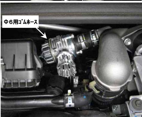
(7) 2-(5)で取付けたゴムホースΦ6を図のようにブローオフ本体のニップルに配管する。
