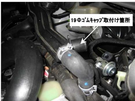
(1) 純正エアバイパスバルブリターン側のエアチューブに19φゴムキャップを付属のクランプを使用して取り付ける。
