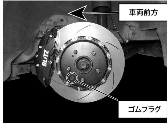
4. キャリパーブラケット、キャリパーボルトを規定トルクで締め付けてください。
