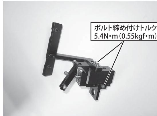
4. ブラケットボルトを使用し、ブレーキローター、ブレーキキャリパー、アタッチメントブラケットを車両へ仮付けしてください。
