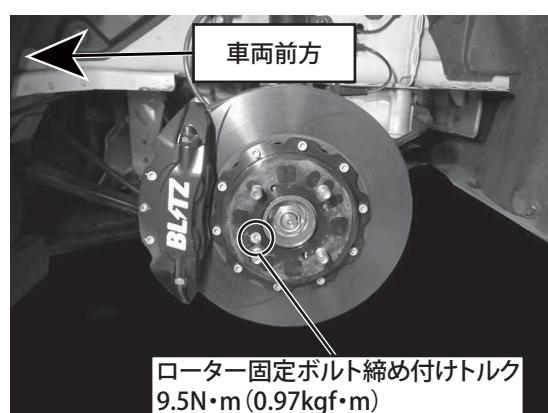
7. キャリパーボルトを規定トルクで締め付けてください。
