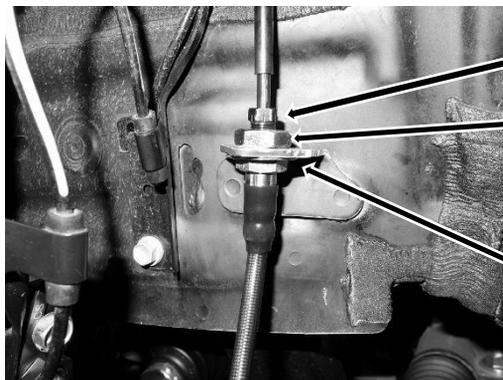
ブレーキパイプナット締め付けトルク
