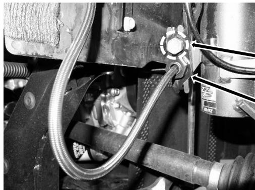
ブレーキホースステー、純正ボルト締め付けトルク
