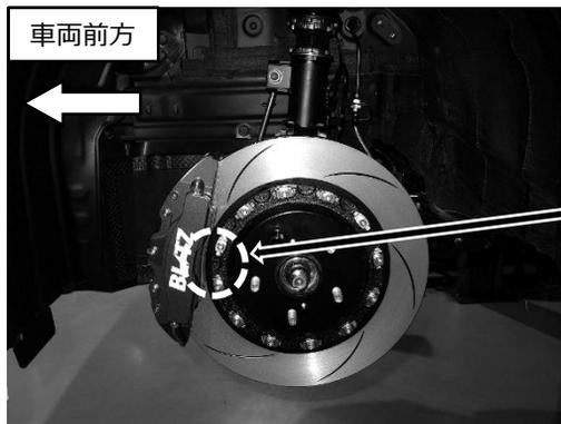
ブレーキローターベルハウジングの外周部とキャリパーの干渉確認箇所
