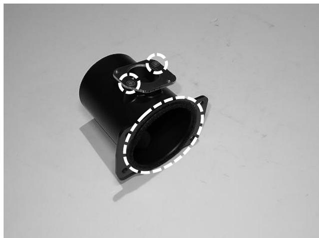
8. 純正エアフロセンサーに Oリングを取り付けしてください。この時純正の Oリングは取り外しせず新たにキット付属の Oリングを取り付けしてください。
