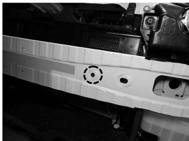
5. 加工した樹脂パネルを元の位置に戻し導入ダクト R,L をそれぞれ取り付けしてください。
