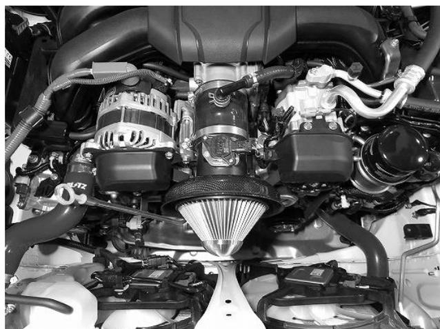
13. ボルト M6×20 を使用しカーボンフィルターケースにステー-A を固定します。ステーのカーボンフィルターケースの間にゴムワッシャーをいれてください。純正グロメットをステー-A に固定してください。
