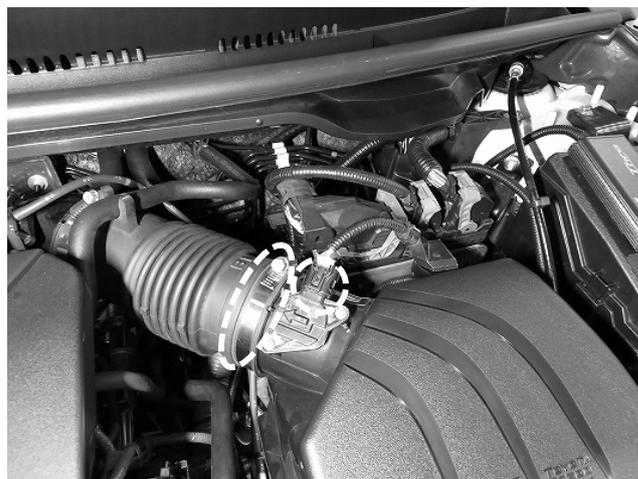
3. 可変バルブアクチュエーターのコネクターとゴムホースを取外し、アクチュエーターをクリーナーボックス下部から取外します。
