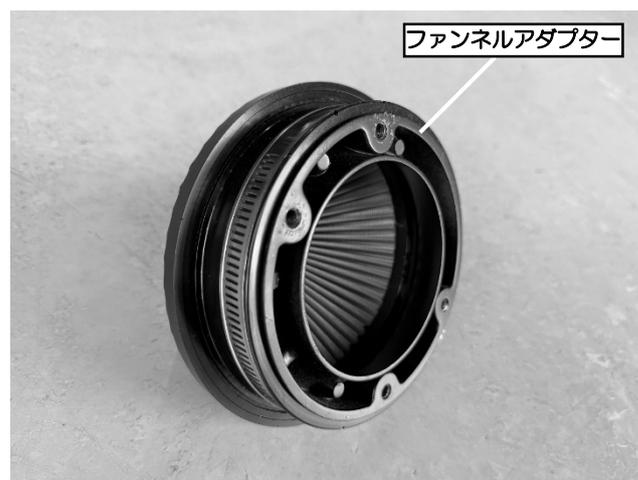
5. 組立てたファンネルアダプターとエアフロアダプターで、フィルターケースを挟み込むようにボルト M6×20 で取付けます。
