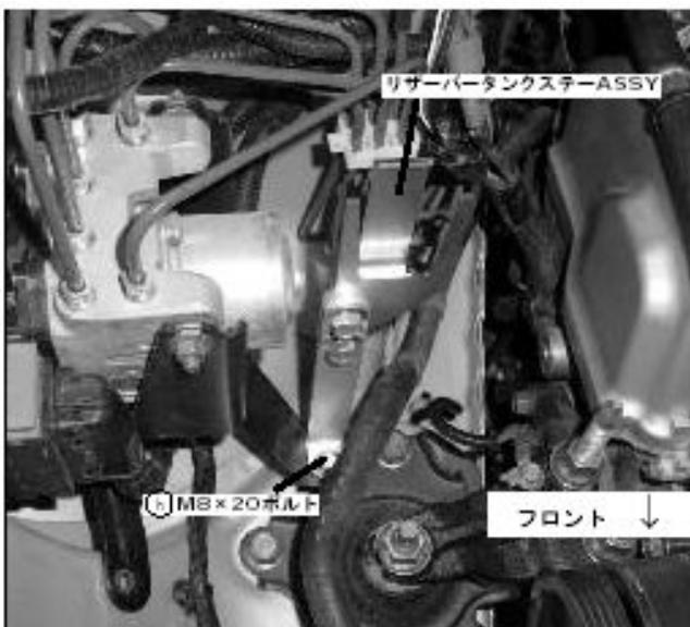
(イ) (ア)で組付けしたリザーバタンクステーASSYを写真の位置に、付属の⑬M8×20ボルトで仮止する。
