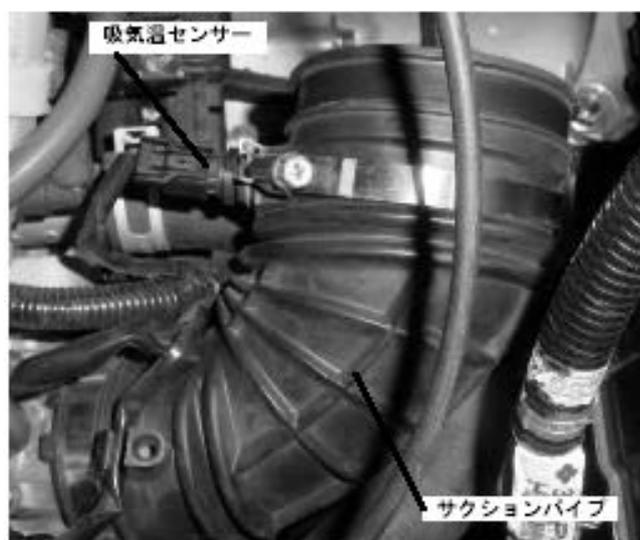
(ウ) 吸気温センサーのカプラー、ホースバンドをはずし、サクシヨンパイプを取外す。取外したサクシヨンパイプから吸気温センサー(センサー部)を取外す。
