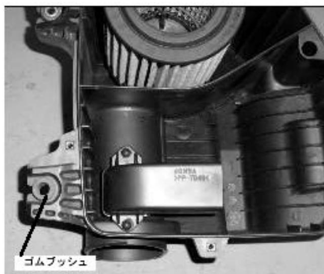
(エ) 取外したエアクリナーボックスの写真部分のゴムブッシュを取外す。メッキのカラーも外しゴムブッシュのみにして下さい。後ほど吸気温センサー取付で使用します。
