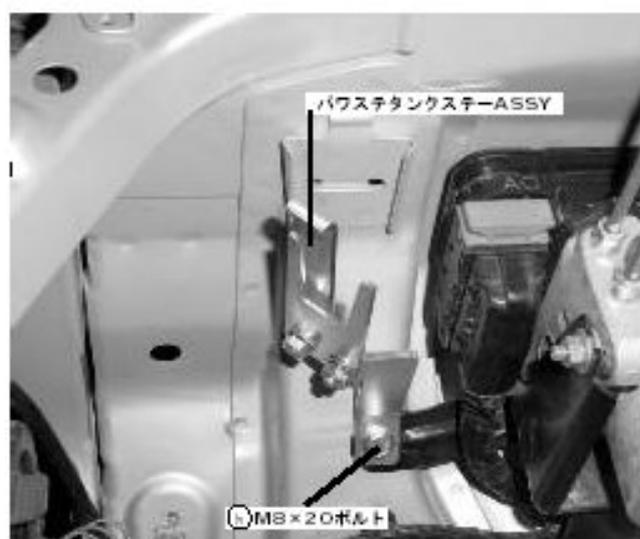
(イ)(ア)で組付けしたパワステタンクステーASSYを、写真の位置に付属の⑰M6×20ボルトで仮止めしてください。
