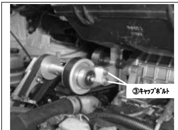
(30)11.プーリーSCドライブと 9.ブラケット(ベアリング)が垂直になる様に位置調整を行い、P16(15)で仮付けした⑩の六角ボルト 2ヶ、を本締めする。
