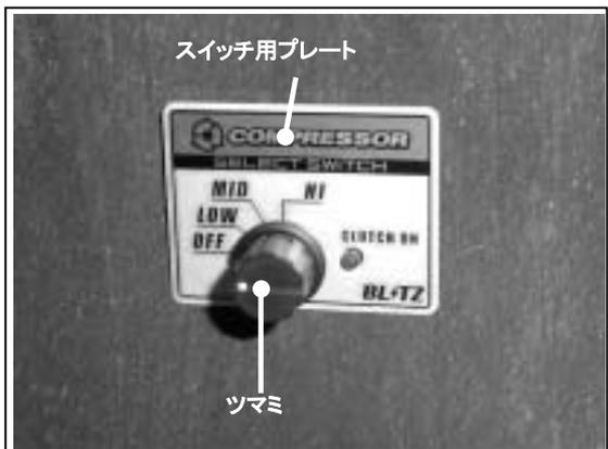
(5) 32 スイッチ用プレート、31 スイッチコントローラ取り付け作業
