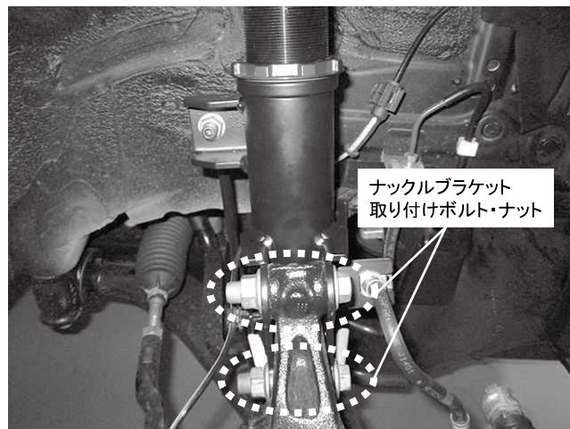
ナックルブラケット 取り付けボルト・ナット 2カ所締め付け 締め付けトルク: 159N・m(16.0kgf・m) ※取り付け上部は長穴になっておりキャンバー調整が可能です
