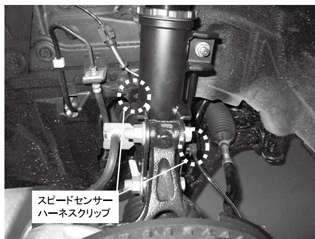
スピードセンサー ハーネスクリップ 2カ所取り付け
