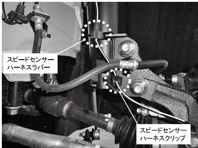
スピードセンサーのラバー・クリップ固定
