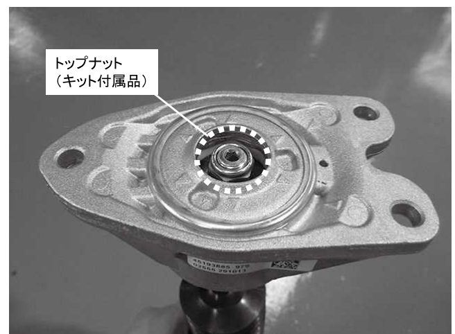
トップナット締め付け 締め付けトルク: 30N・m(3.1kgf・m)
