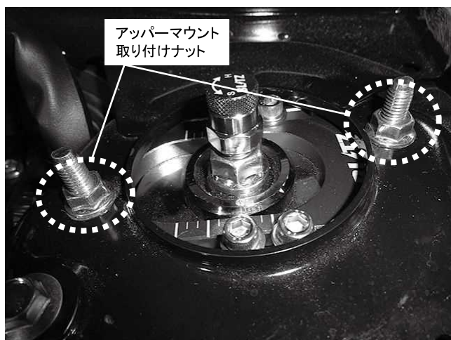
アッパーマウント取り付けナット 2カ所締め付け 締め付けトルク: 31N・m(3.1kgf・m) ※製品付属のM8ナットを使用してください
