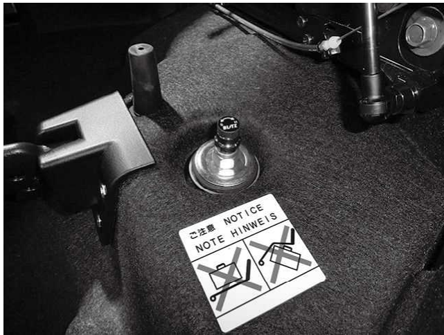
トップナット締め付け状態 ※写真はトランク内です
