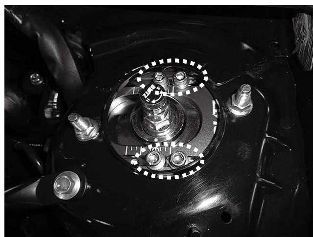
ピロアッパーマウントでキャンバー調整する際 ストラットタワー開口部とキャンバー調整ボルトが 干渉しないよう注意してください
