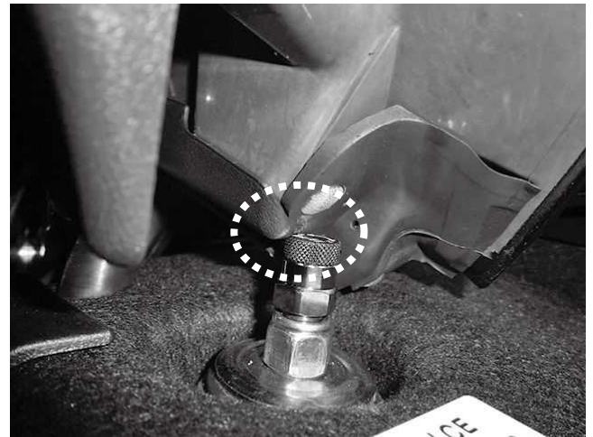
ルーフ開閉時に減衰ダイヤルとルーフ室内側 樹脂部分が少し干渉することがあります その際は干渉部分を削るなど加工してください
