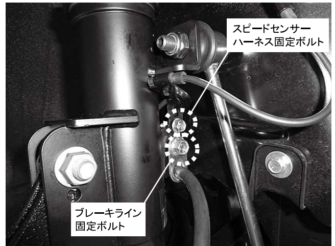
ブレーキライン固定ボルト 1カ所締め付け 締め付けトルク: 24.5N・m(2.5kgf・m) スピードセンサーハーネス固定ボルト 1カ所締め付け 締め付けトルク: 9.8N・m(1.0kgf・m)
