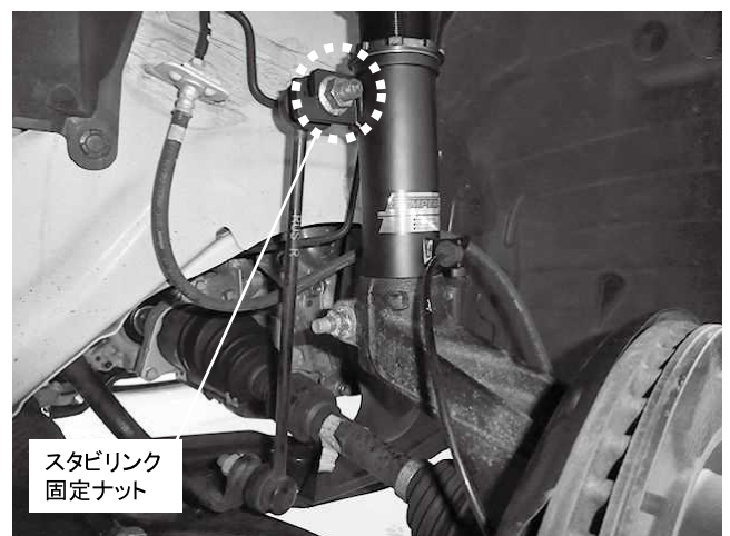
スタビリンク固定ナット 1カ所締め付け 締め付けトルク: 84N・m(8.6kgf・m)
