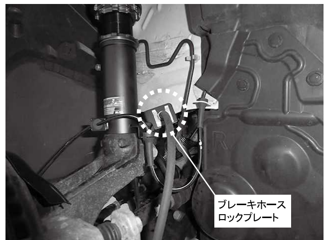
ブレーキホースロックプレート取り付け ※ブレーキホースと他部品が干渉していないか 確認してください
