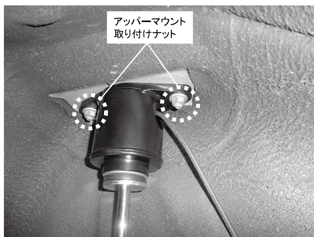
リアショックアッパーマウント取り付けナット 2カ所締め付け
