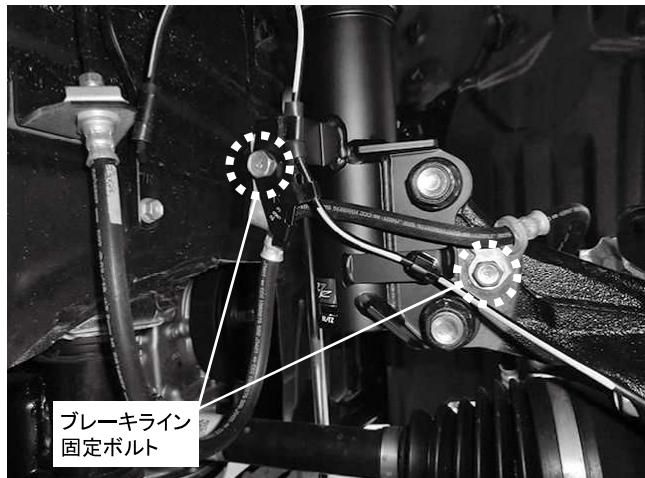
ブレーキライン固定ボルト 2カ所締め付け
