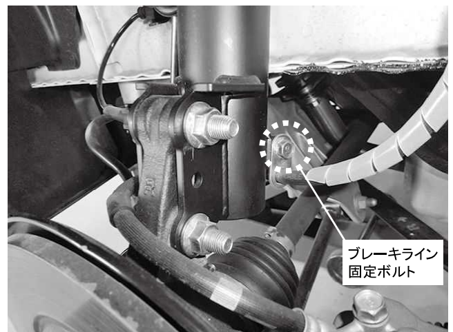
ブレーキライン固定ボルト 1カ所締め付け 締め付けトルク: 22N・m(2.2kgf・m)
