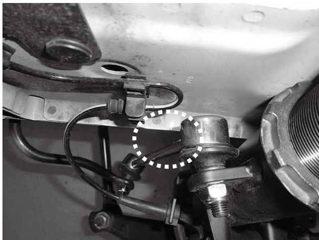
車両構造上スタビリンクとボディとの クリアランスが狭くなります 干渉がないか確認してください
