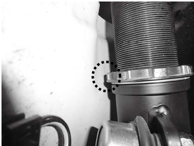
車両構造上ロックシートとボディとの クリアランスが狭くなります 干渉がないか確認してください
