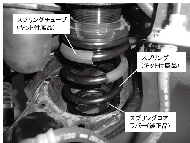
リアスプリング取り付け状態 ※スプリングをサスペンションアームに取り付けの際、 スプリング下部に純正スプリングロアラバーを取り付けてください ※スプリングが線間密着する際、必要に応じてスプリング チューブを使用してください
