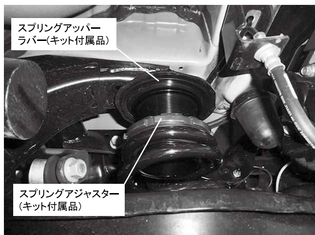
リアスプリング取り付け状態 ※スプリングアジャスター取り付けの際、アジャスター上部に キット付属品スプリングアッパーラバーを取り付けてください 純正のスプリングラバーは使用しないので取り外してください
